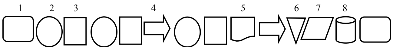
Рис. 15. Диаграмма потока процессов: 1 – начало (конец), 2 – технологические операции, 3 – контроль, 4 – транспортировка в другой цех, 5 – документ на готовое изделие, 6 – хранение, 7 – электронная копия документа, 8 – банк данных [16]
